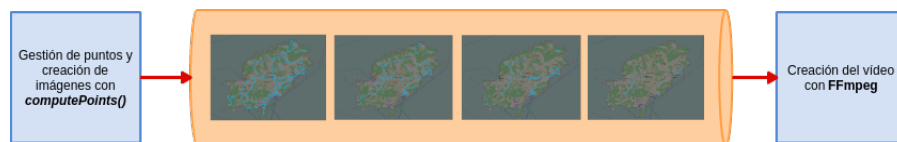
Figura 9.4: Tubería ( pipe ) por la que se envían las imágenes del buffer de memoria a FFmpeg
